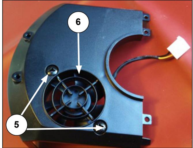
Figure 43: Replacing the base fan
